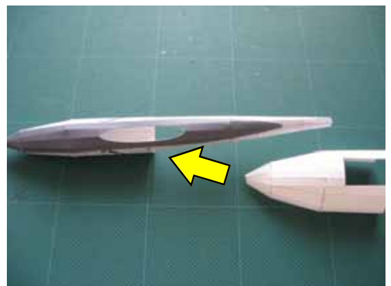
6 . A2:機首補強2を機首の内側にのりづけする
